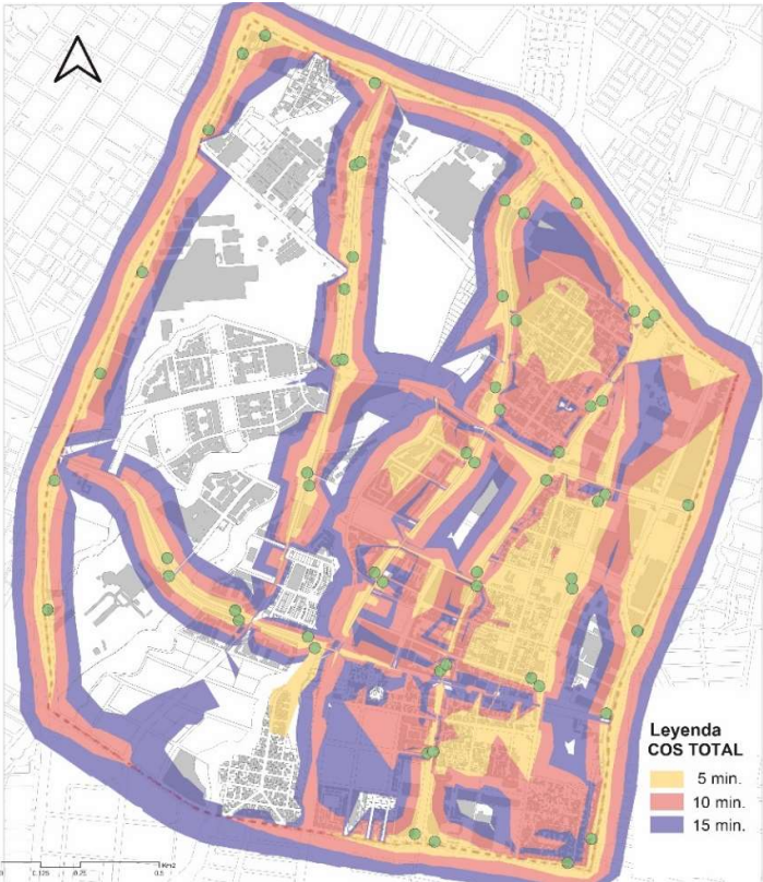
Figura No. 14 Cobertura Caminable Transporte Publico
