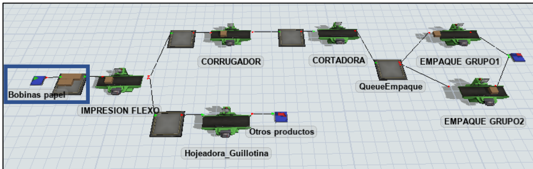
Figura 24. Representación del proceso mejorado de la producción de láminas single facer de flores.
