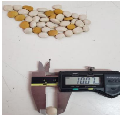
Figura 9. Medición de un grano de chocho con el pie de rey.
