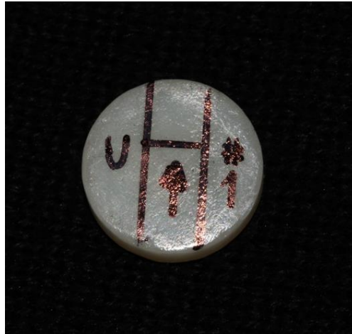
Figura 10: Codificación del número y área de trabajo de la muestra para el sistema Jiffy Universal Intraoral - Ultradent. Numero en la parte derecha de la muestra. Área de trabajo en la parte superior
