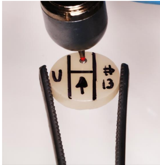
Figura 13: Desgaste de superficie experimental con fresa en forma de platillo con diamante de grano fino (Cool Cut, Israel), empleando abundante irrigación de agua. Sistema Ultradent
