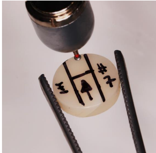
Figura 11: Desgaste de superficie experimental con fresa en forma de platillo con diamante de grano fino (Cool Cut, Israel), empleando abundante irrigación de agua. Sistema Eve
