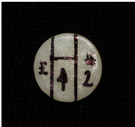
Figura 8: Codificación del número y área de trabajo de la muestra para el sistema Ecoceram – Eve. Numero en la parte derecha de la muestra. Área de trabajo en la parte superior
