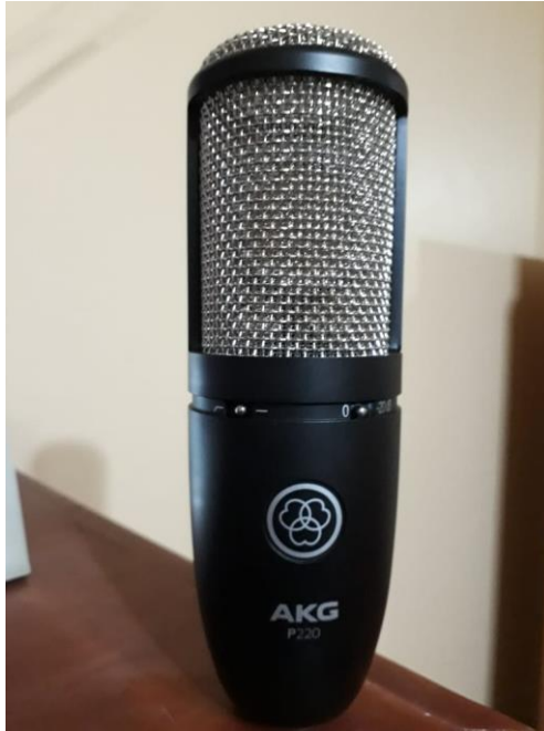
Figura 14. Micrófono de condensador de diafragma grande AKG P220
