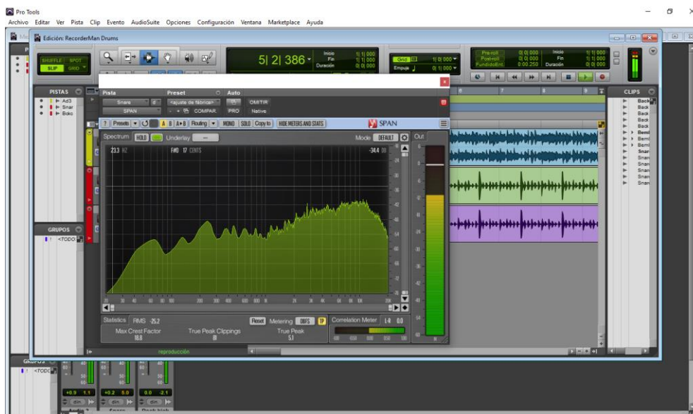
Figura 35. Analizador de espectro SPAN, micrófono por encima del redoblante.
