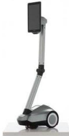
Figura 16. Robot de telepresencia PadBot P2. Tomado de (Telepresence Robots, 2016)
