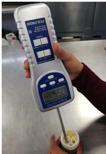
Figura 8. Determinación de la dureza con un penetrómetro digital.
