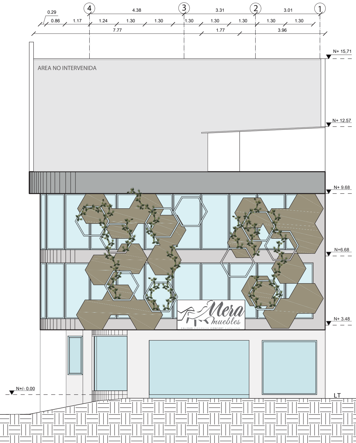
FACHADA FRONTAL INTERVENIDA INTERIORISTA ESCALA 1: 100
