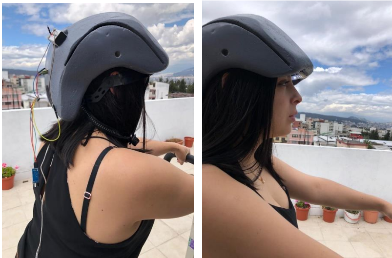
Figura 92 Evidencia fotográfica de la validación de experiencia: prueba de vibración y visión de luz led bajo luz solar
