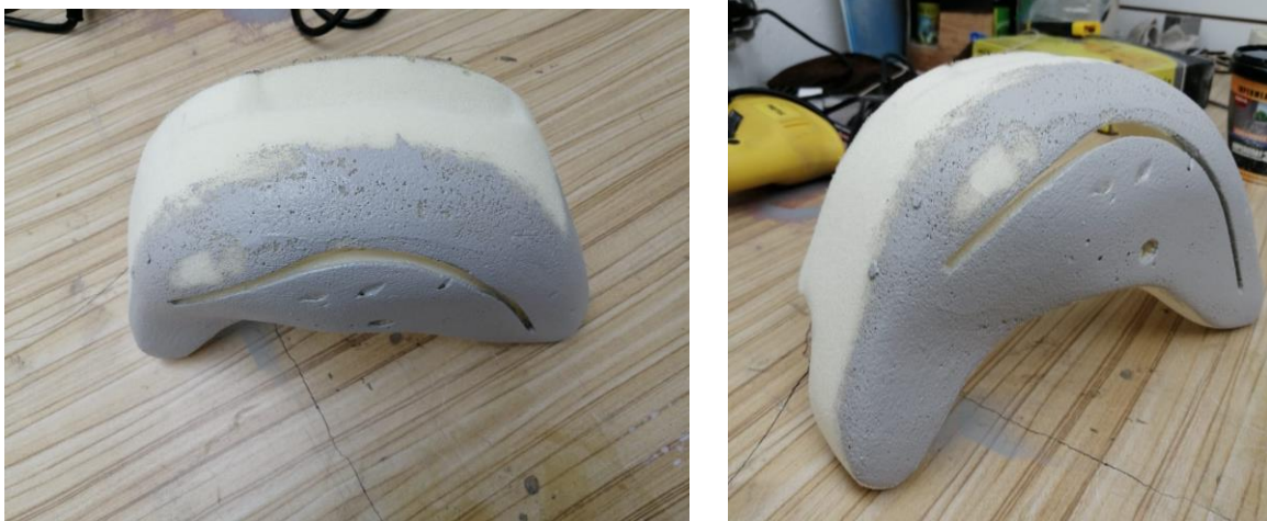
Figura 79 Primeros acabados piezas de casco
