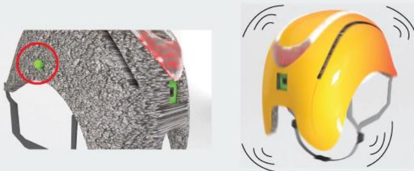
Motores de vibración se activan en 3 puntos distintos del casco cuando un obstáculo entra al campo de alerta
