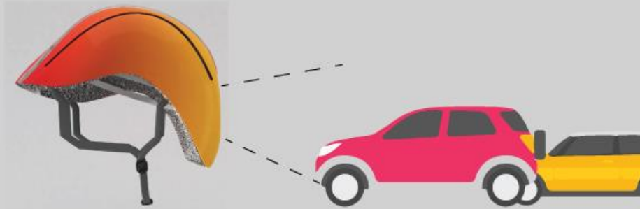
Visión artificial para la detección de obstáculos, Cámara integrada con ángulo de visión de 54x41
