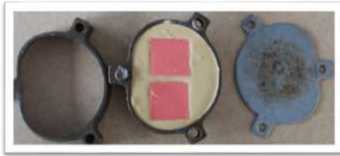
Figura 2: patrones de cera hacia la mufla con yeso piedra
