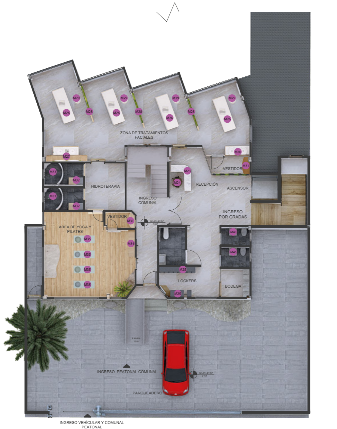
PLANO DE MOBILIARIO PLANTA BAJA ESCALA 1:150
