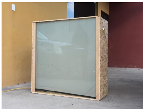
Figura 25 Caja de ensayo lamina inteligente LCDP en vidrio 6mm, apagado (opaco)
