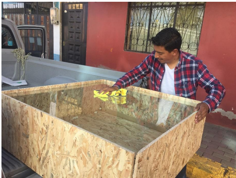
Limpieza del vidrio de 6mm cara del vidrio que estará en la parte interna de la caja del ensayo
