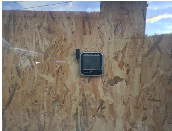
Figura 37 Medición de Temperatura interna, caja de ensayo lamina inteligente PDLC en vidrio 6mm estado Encendido
