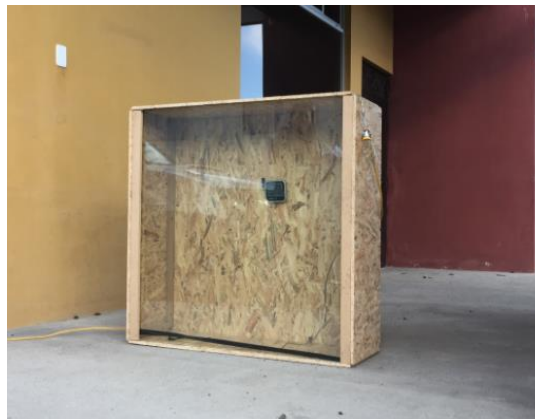
Figura 24 Caja de ensayo lamina inteligente LCDP en vidrio 6mm, encendido (transparente)
