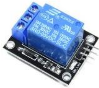
Figura 31 Modulo Relé KY-019 5V.
