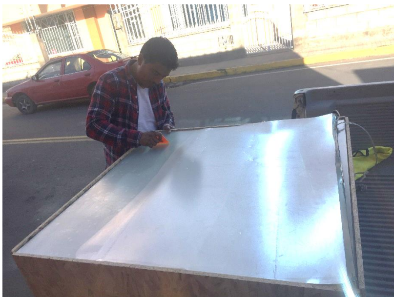
Pegado de lámina inteligente PDLC sobre la cara de vidrio 6mm
