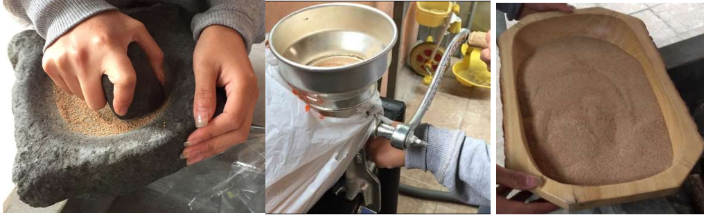
Figura 13. Proceso de molienda de las pepas de durazno.
