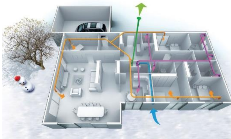
Figura 20. Ventilación Mecánica en una casa
