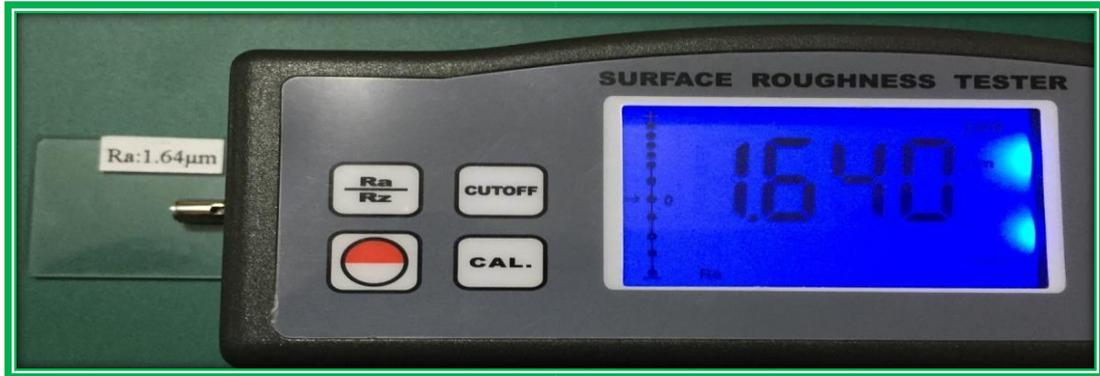
Figura 23: Medida de Rugosidad (Ra) obtenida en la pantalla led del Rugosímetro
