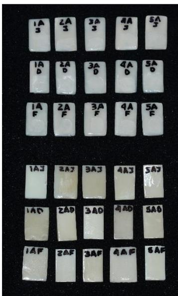
Figura 2 Muestras experimentales. (Pastillas rectangulares cerámica feldespática Solera Italiana con certificación Española y pastillas rectangulares de zirconia casa comercial Zirkonzahn).
