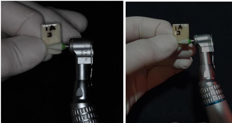
Figura 4 Pulidor de cerámica feldespática y zirconio: segundo paso (jota kit Ceramic Polisher, Switzerland).
