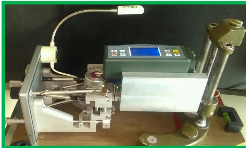
Figura 24: Equipo de medición de la Medición de la Rugosidad (Ra) en cerámicas y Zirconios.
