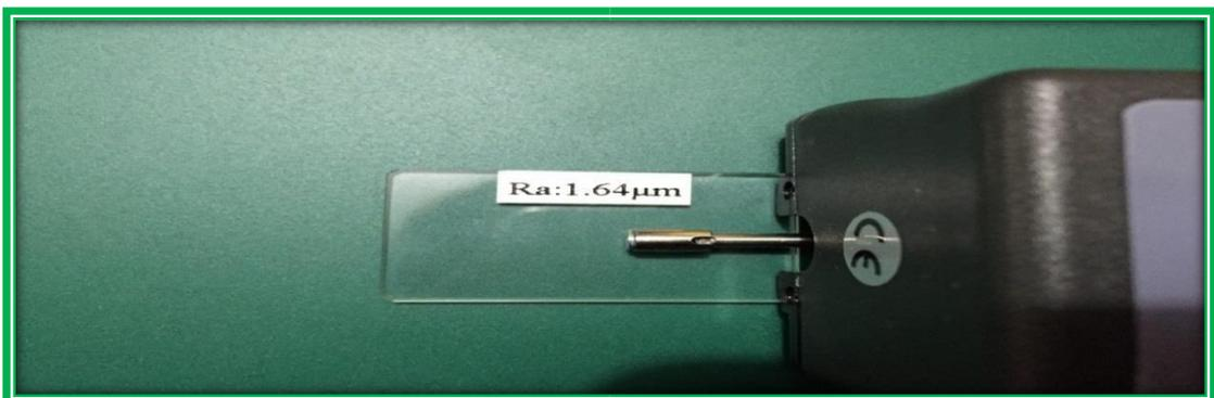
Figura 22: Verificación de la Rugosidad (Ra) con Patrón del Equipo
