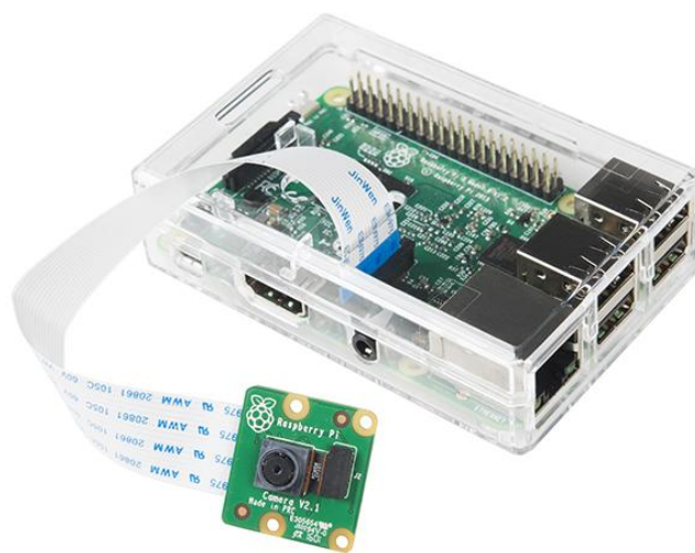
Figura 17. Conexión de la Pi cámara a la unidad de procesamiento.
