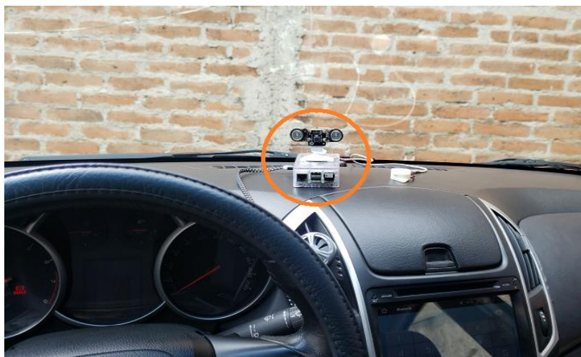
Figura 41. Ubicación específica de la cámara anti somnolencia.
