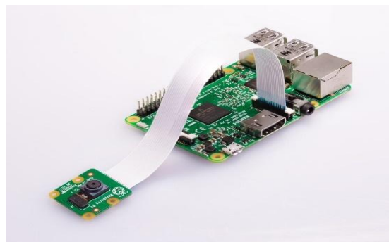
Figura 21. Conexión de la cámara a través del puerto por defecto Raspberry.
