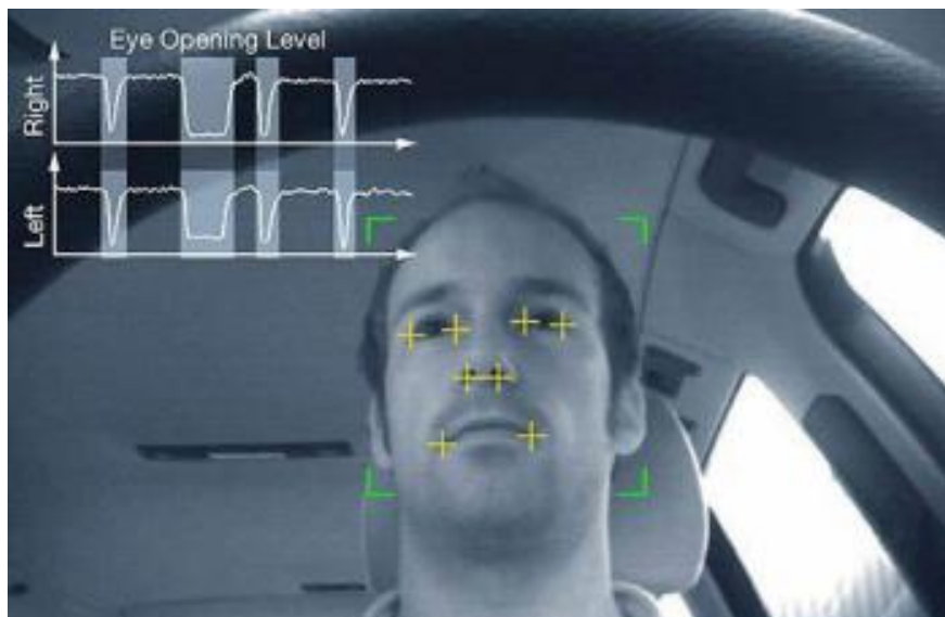
Figura 9. Sistema detector de somnolencia.
