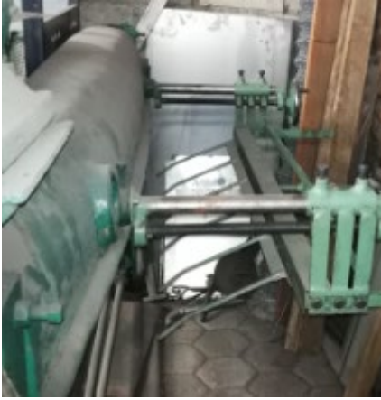
Figura 41. Colocación de topes para corte en cizalla mecánica
