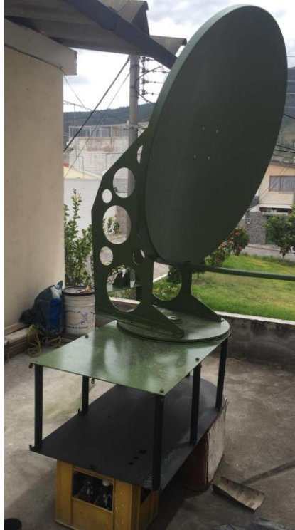
Figura 100. Ensamblaje final de la estructura y bases de la antena.
