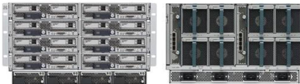
*Figura 16.*Cisco UCS 5108 parte posterior y delantera.
