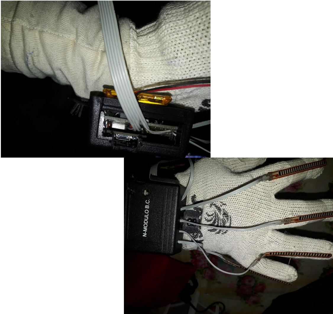
Figura 52. Sujeción del case y posición de sensores
