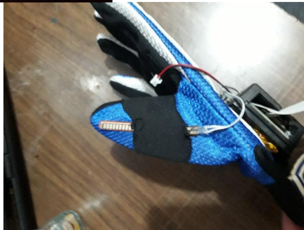
Figura 54. Colocación de sensores y modulo
