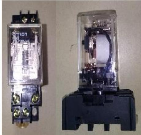
**Figura 45.** Relé Omron de 12V. Tomado de: (Schneider Electric, 2013).
