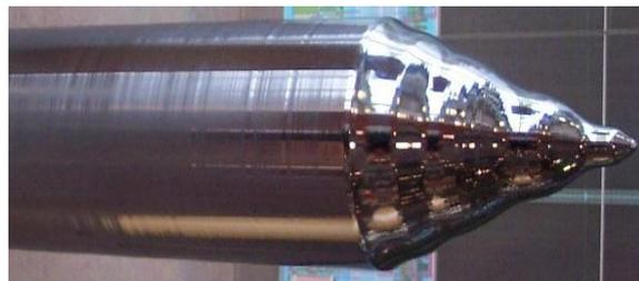
**Figura 3.** Silicio Monocristalino. Tomado de: <http://naukas.com/2011/12/13/cuestion-de-impurezas/>
