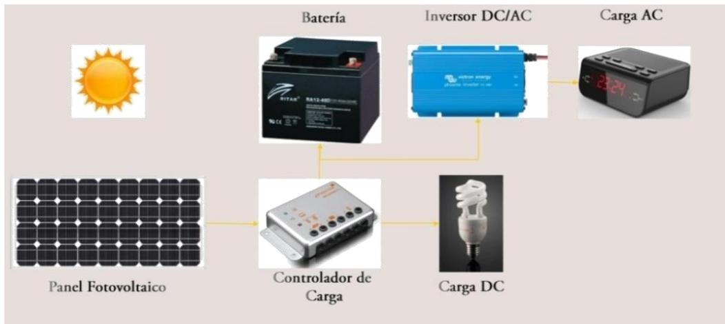
**Figura 9.** Componentes de un sistema fotovoltaico. Adaptado de: Briceño, 2010
