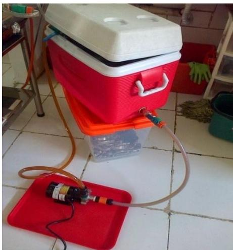
Figura 65: Bomba conectada para la recirculación
