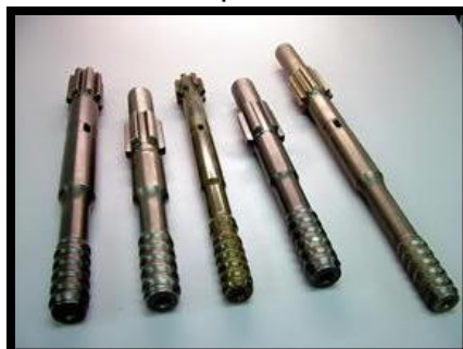
Figura.1.5. Shank o Adaptador de Culata
