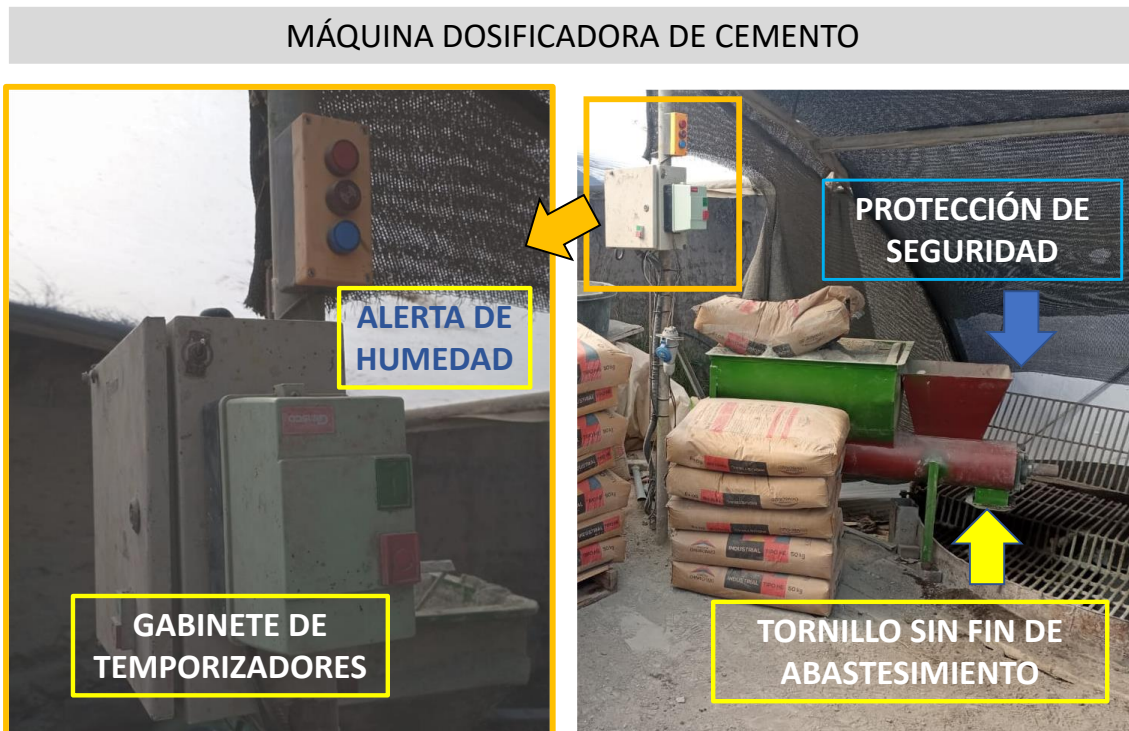
Figura 11. Máquina de dosificación de cemento y alerta de porcentaje de humedad
