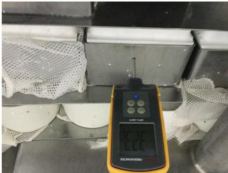
*Figura 22.* Toma de temperatura del queso fresco durante prensado
