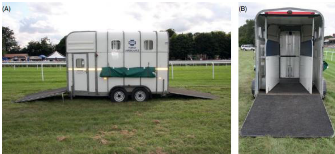
Figura 17 Sistema de remolque con rampa delantera y trasera. Tomado de A. E. Fürst, 2012.
