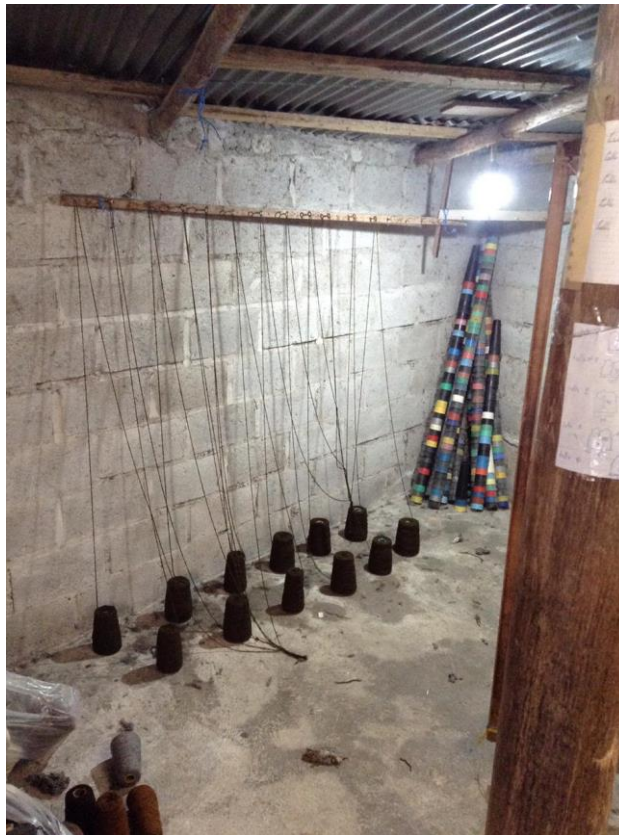
Figura 37. Lana enconada en posición para urdir
