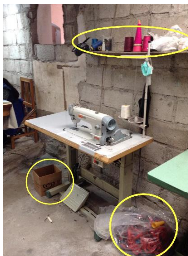
Figura 82. Área de confección con material en desorden y cosas innecesarias
