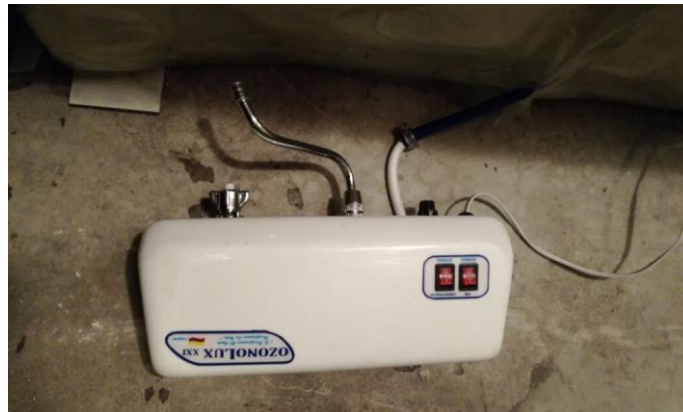
Figura 8. Generador de ozono.
