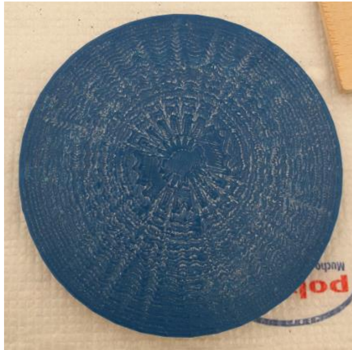
Figura 43. Subreflector con material ABS
