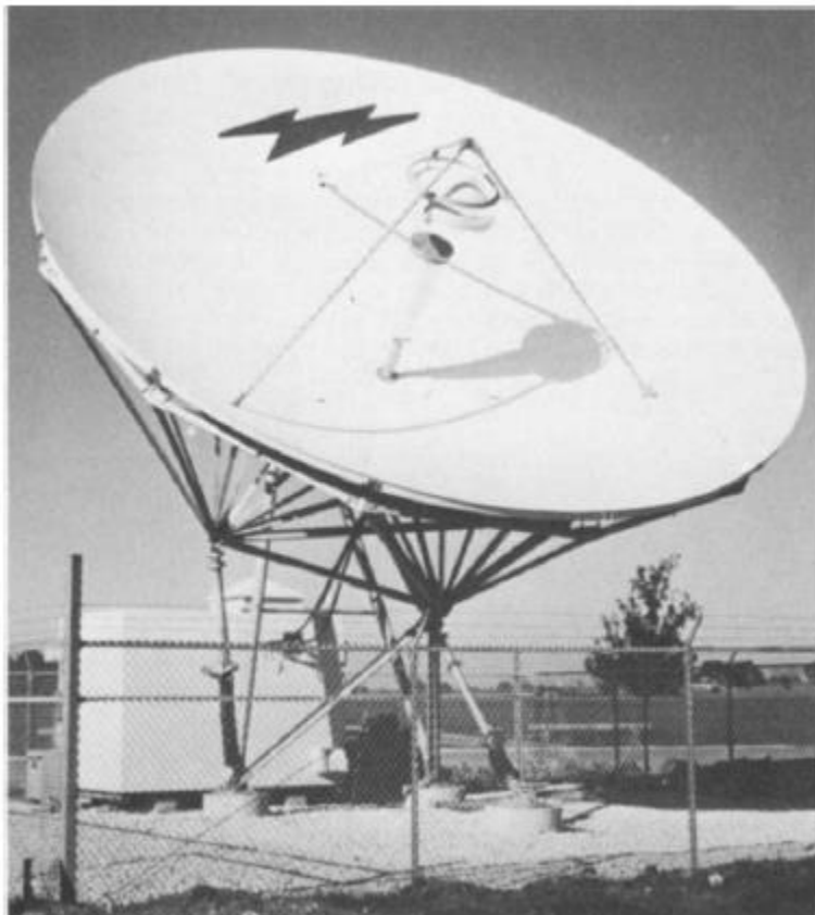
Figura 21. Antena Cassegrain clásica
