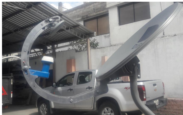
Figura 62. Antena Cassegrain offset instalada
