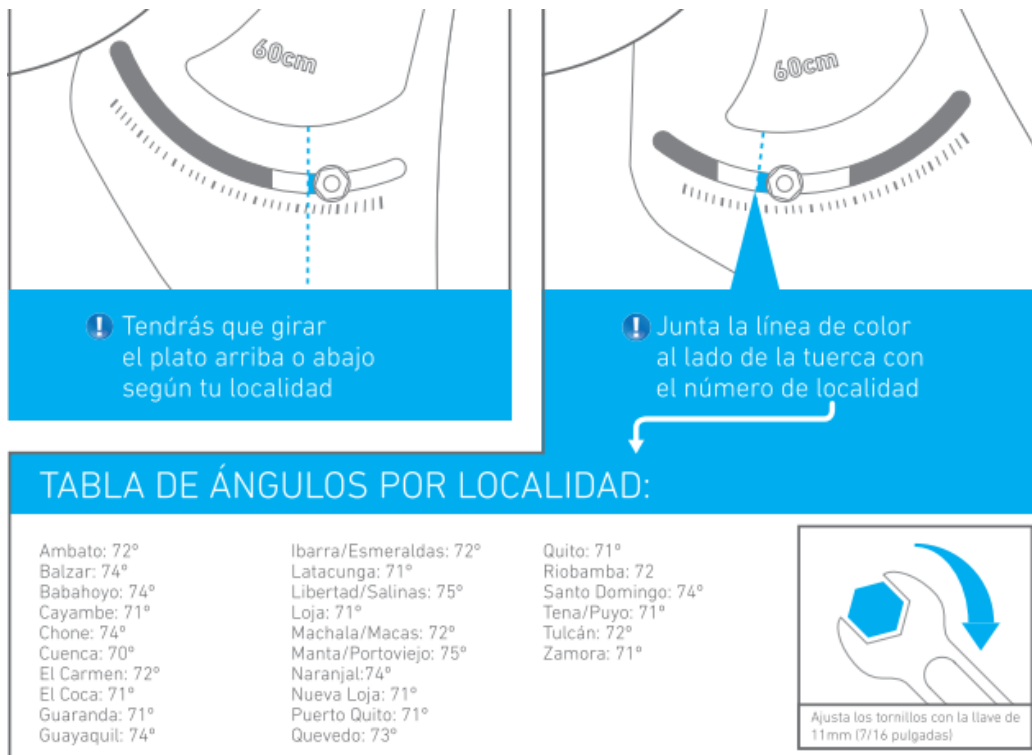
Figura 59. Instalación antena DIRECTV – Paso4
