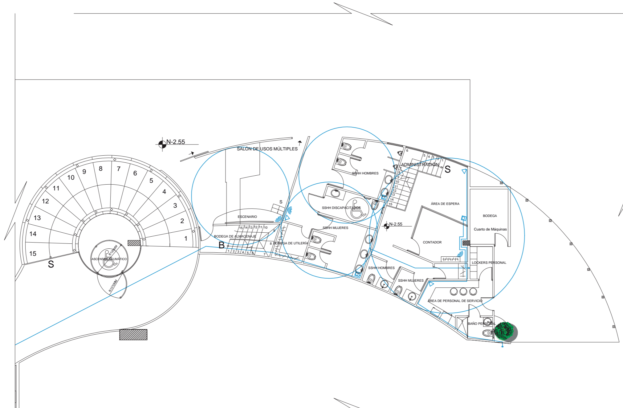
PLANO DE INSTALACIONES VOZ Y DATOS - PLANTA NIV -2.55 SECCIÓN 1 ESC 1:150
