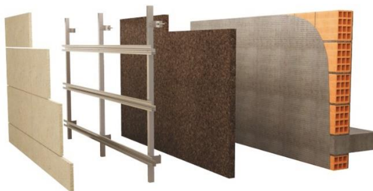
Figura 18. Colocación de corcho como aislante.
