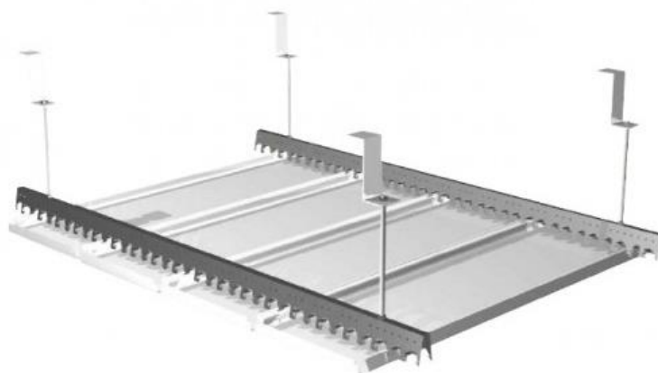
Figura 19. Detalle colocación cielo falso metálico.
