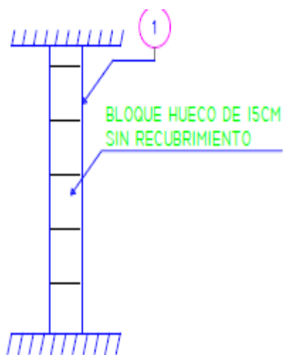
Figura 33 : Bloque hueco de 15cm sin recubrimiento (AUTOCAD)
