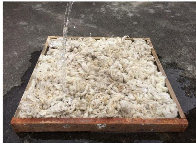
Figura 25 Compactar con agua caliente
