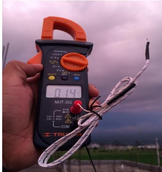
Figura 35 Toma de medidas de temperatura con pinza amperimétrica.
