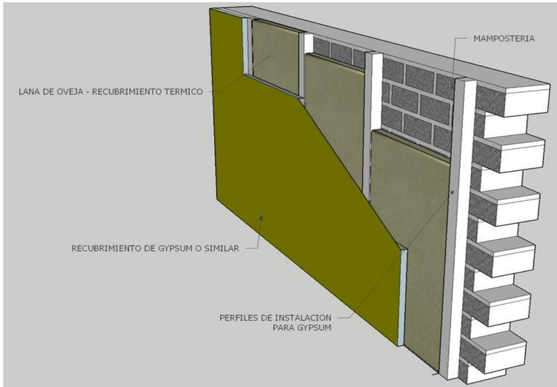
Figura 28 Instalación lana de oveja: vista lateral.
