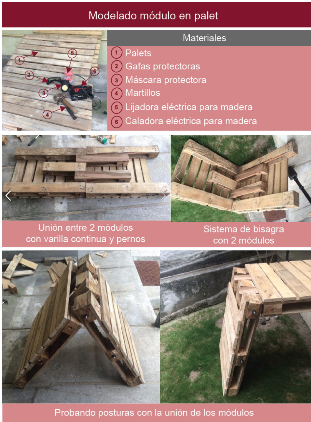
Figura 35. Modelado módulo en palet, escala 1:1
