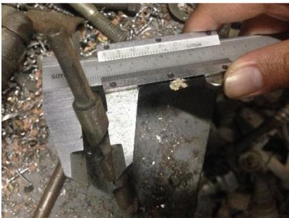
*Figura 41.* Medición del diámetro de la broca
