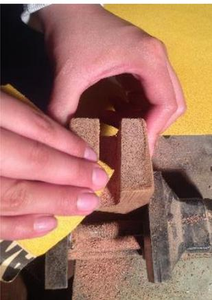
*Figura 44.* Lijado de la pieza
