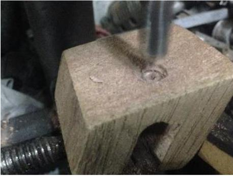
*Figura 46.* Perforación para incrustación del imán
