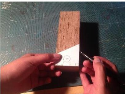
*Figura 39.* Dibujo de líneas guía en la madera
