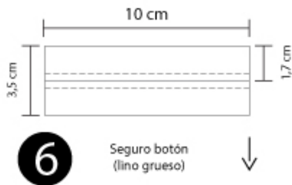
Figura 97. Molde pieza “Seguro botón”, escala 1:2.
