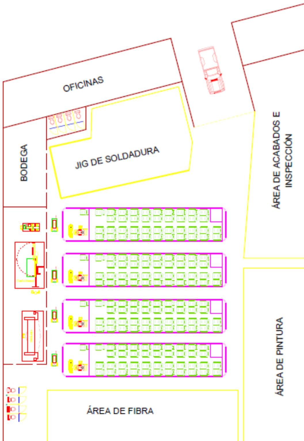
Figura 30. Distribución de planta de servicio de BUS STAR SERVICE S.A.
