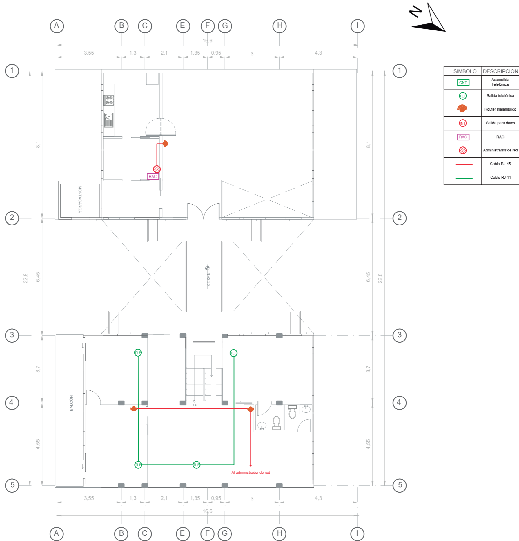
PLANTA ALTA INSTALACIÓN VOZ Y DATOS Esc: 1:120
