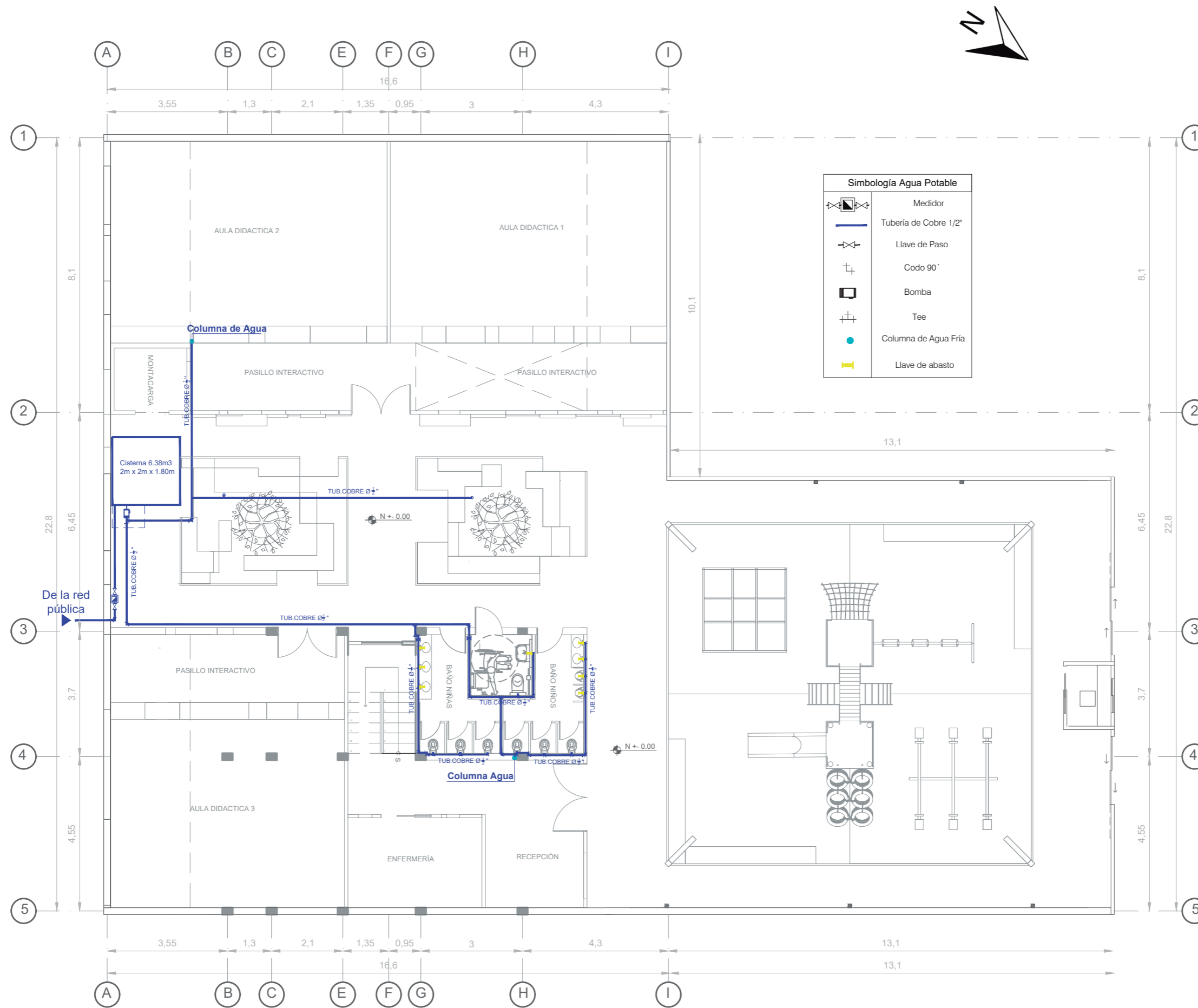
PLANTA BAJA INSTALACIÓN AGUA POTABLE Esc: 1:120
