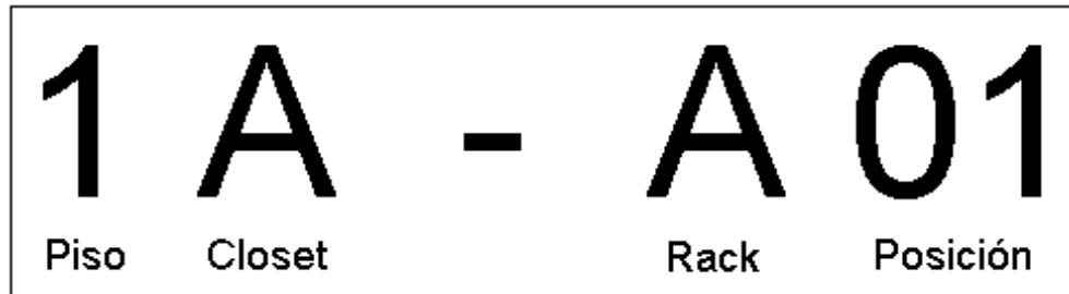
Figura 37. Etiqueta Cable UTP.
