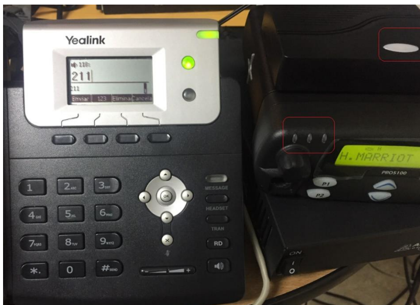
Figura 29. Llamada Teléfono IP a Gateway.
