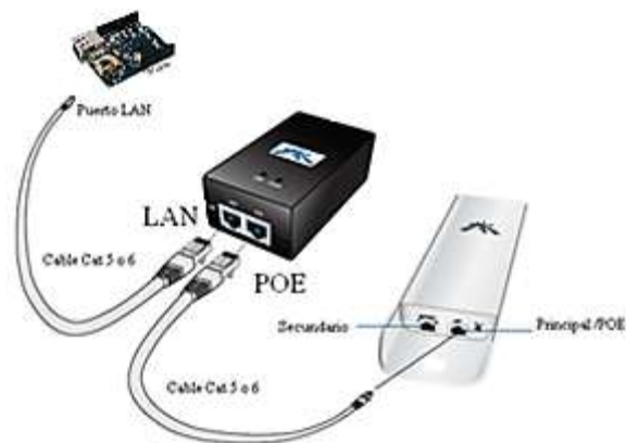
Figura 28. Energización del radio M2 a través del puerto Ethernet del PoE. Adaptado de: Ubiquiti networks , 2013
