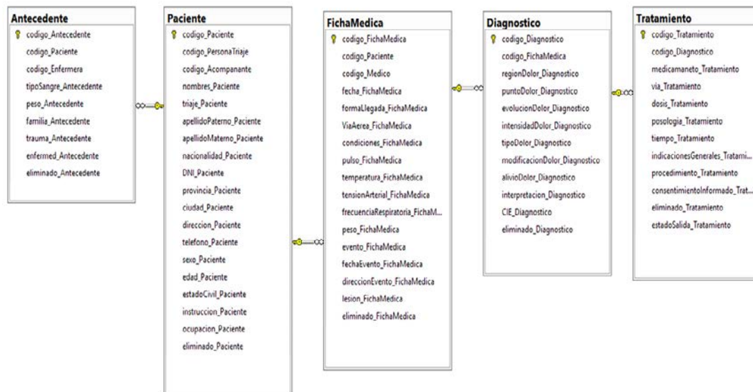
Figura 20. Diagrama Relacional de Base de Datos SHC de tablas con Información del Paciente.
