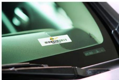
*Figura 3.* Etiqueta RFID en un parabrisas
