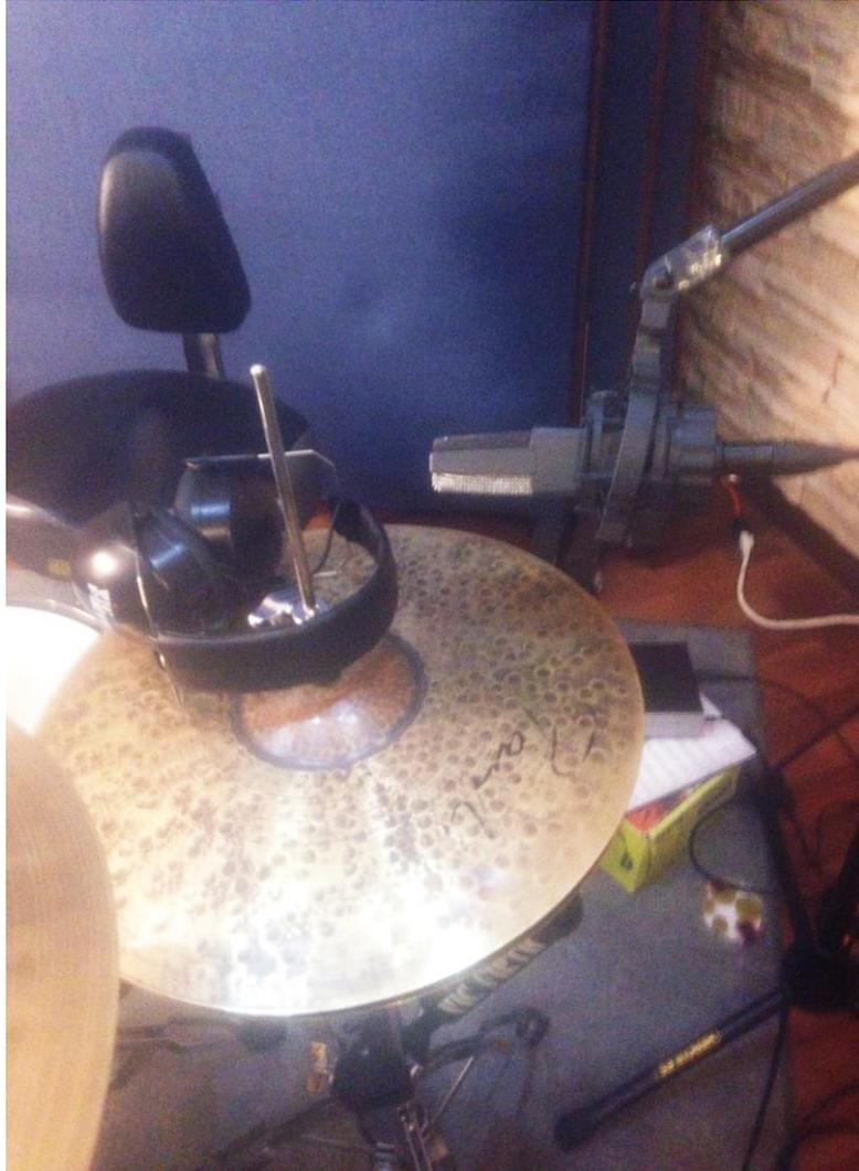
Figura N: 32, Explica la microfónica utilizada para la grabación de los *Cymbals* (Técnica *Over Heads*). Grabación batería, Plano general microfónica.
