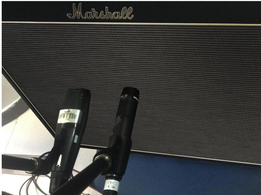
Figura N: 27. Explica la microfónica en la grabación de amplificadores, apuntando el SM57 al eje y MD421 fuera de eje.
