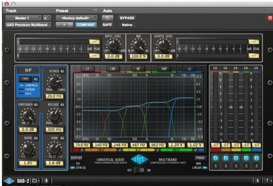
Figura N: 51. Explica el trabajo de compresión por bandas de frecuencia. Interfaz Avid Protools 10 HD.
