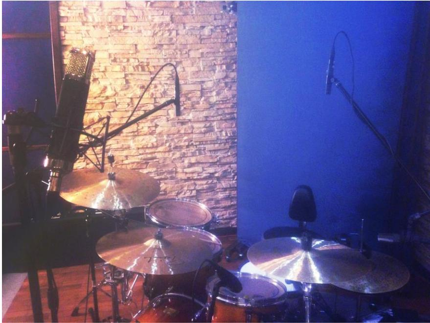
Figura N: 33, Explica la microfónica utilizada para la grabación de los *Cymbals* (Técnica *Over Heads*). Grabación batería, Plano general microfónica.
