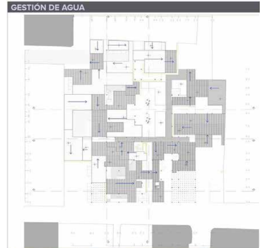
Figura 182. Esquema de inclinación de cubiertas para recolección de agua
