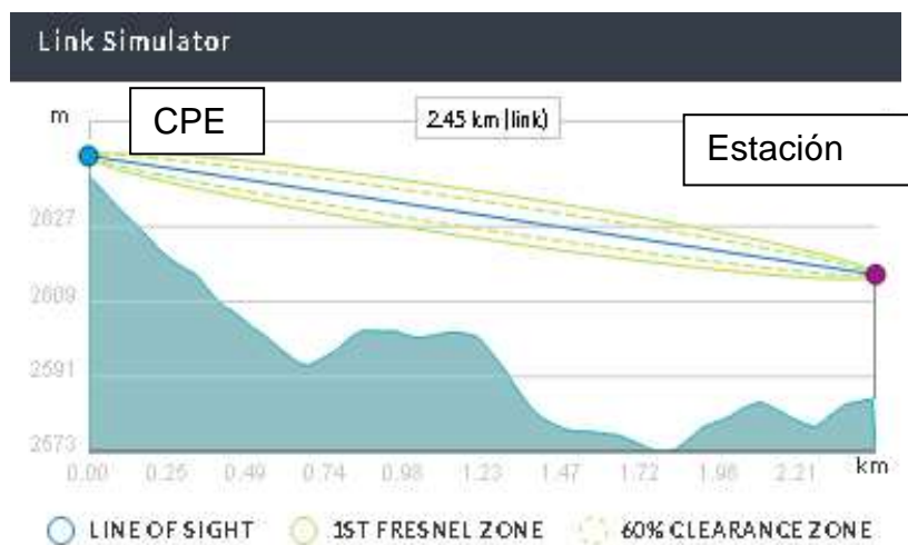
Figura 64. Zona de Fresnel estación base – zona noroeste en AirLink.
