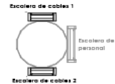
UBICACION DE ESCALERA DE CABLES
