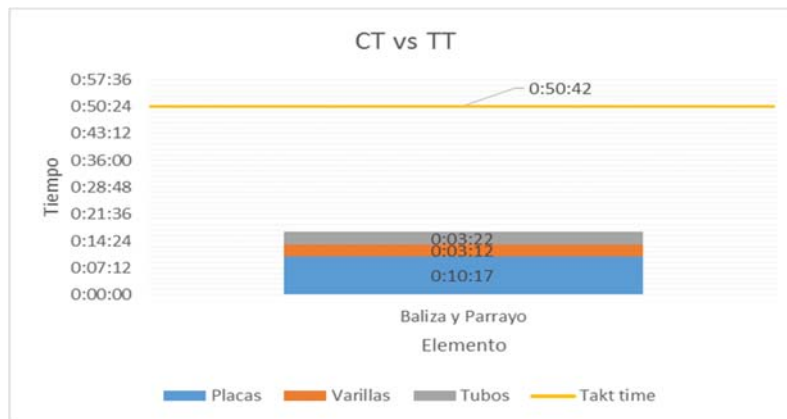
Figura 47. CT vs TT Soporte de Baliza y Pararrayo Antes.
