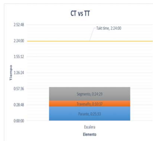
Figura 16. CT vs TT Escaleras Antes.
