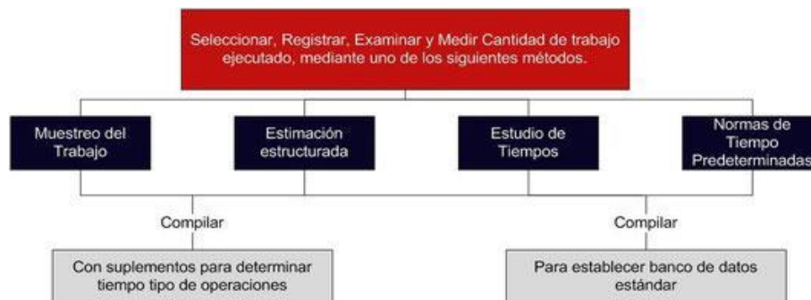
Figura 10: Técnicas de medición del trabajo
