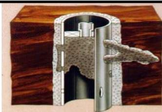
FIGURA 27. Cementación forzada para reparar casing
