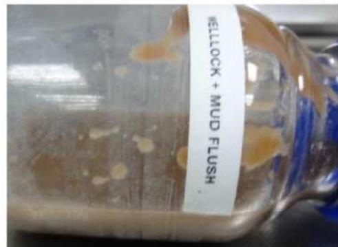
MUESTRA CONTAMINADA CON MUD FLUSH MUESTRA LEVE GELIFICACION DEL WELLOCK
