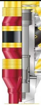
FIGURA 42. Retenedor de Cemento
