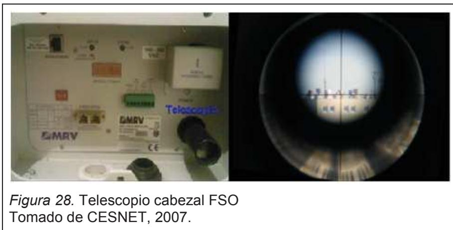
La alineación se lo realiza en dos pasos. El primer paso es una alineación aproximada, la que se realiza con los equipos apagados los cuales se dirigen el uno hacia el otro, este tipo de alineación de la realiza con la ayuda de un telescopio que viene incorporado en los equipos FSO (Figura 28).
