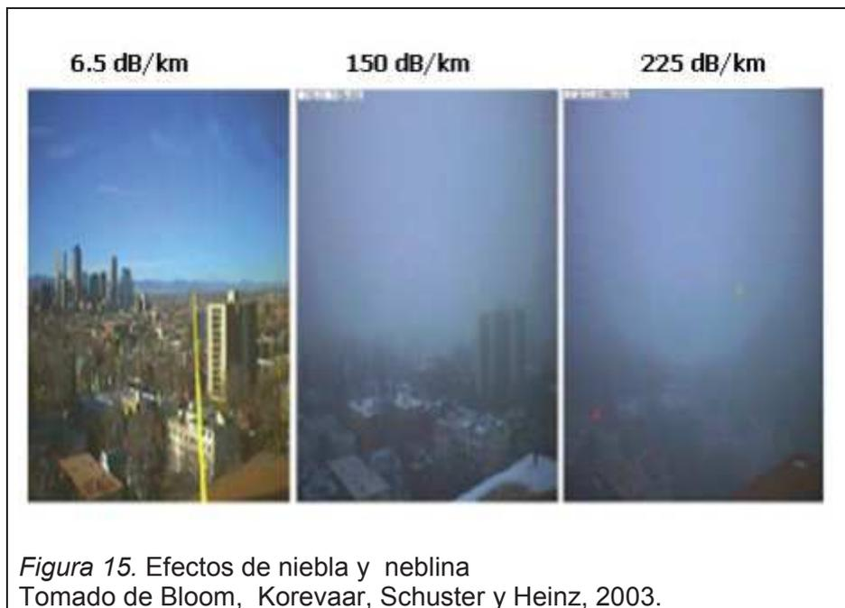
En la Tabla 2 se detalla las diferentes condiciones meteorológicas y la atenuación esperada para la señal en [dB/Km] además de su correlación a la visibilidad.
